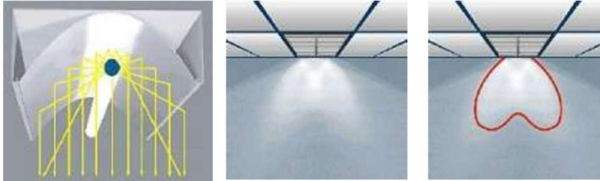
A **curva de distribuição luminosa** é apresentada em coordenadas polares (cd/1000 lm) para diferentes planos. São estas curvas que indicam se a lâmpada ou calha de iluminação tem uma distribuição de luz concentrada, difusa, simétrica, assimétrica, etc.
