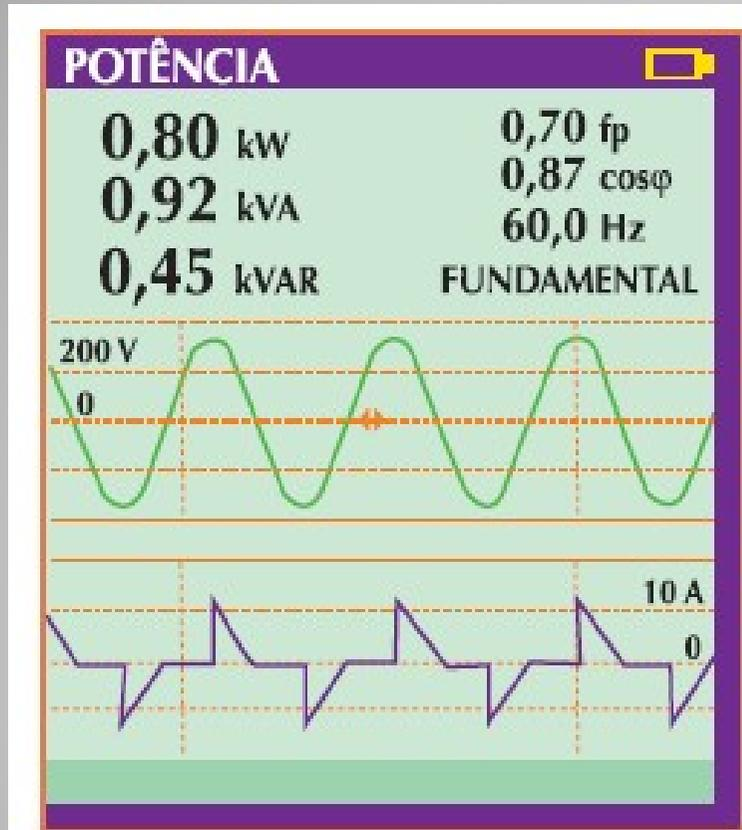
Mede-se o  $\cos\phi$  da componente fundamental e o fator de potência do sinal deformado (total).
